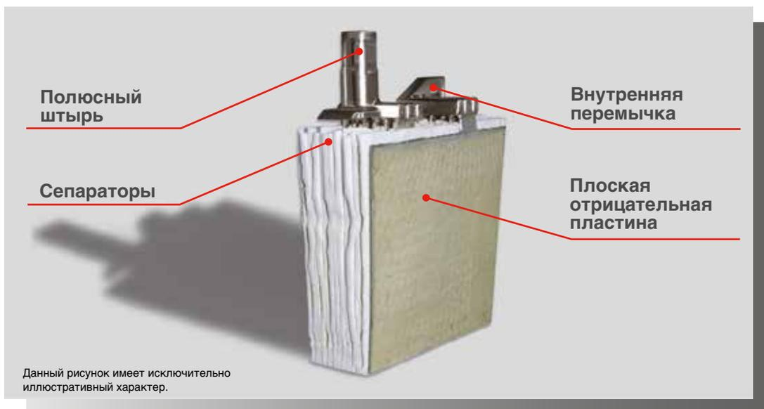
В АККУМУЛЯТОРАХ FIAMM FGL ПРИМЕНЯЕТСЯ ТЕХНОЛОГИЯ AGM (ABSORBED GLASS MAT – ПОРИСТЫЙ ЗАПОЛНИТЕЛЬ ИЗ СТЕКЛОВОЛОКНА). ЭЛЕКТРОЛИТ ПОЛНОСТЬЮ ВПИТЫВАЕТСЯ В СТЕКЛОВОЛОКОННЫЙ СЕПАРАТОР, ЭФФЕКТИВНОСТЬ РЕКОМБИНАЦИИ ГАЗОВ СОСТАВЛЯЕТ 99%. БЛОКИ ОТЛИЧАЮТСЯ ПРОЧНОСТЬЮ, ГЕРМЕТИЧНОСТЬЮ И НЕ ТРЕБУЮТ ДОЛИВКИ ЭЛЕКТРОЛИТА В ТЕЧЕНИЕ ВСЕГО СРОКА СЛУЖБЫ. НИЗКИЙ УРОВЕНЬ САМОРАЗРЯДА ПОЗВОЛЯЕТ ХРАНИТЬ БАТАРЕИ БЕЗ ЗАРЯДКИ ДО 6 МЕСЯЦЕВ.
